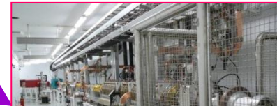
150MeV linear accelerator
